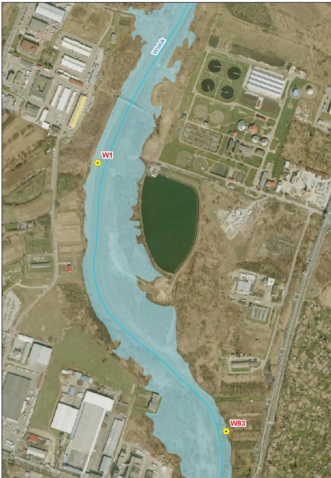
Ryc. 142. Lokalizacja wylotów kanalizacji deszczowej do Wisłoka - cz. 3
