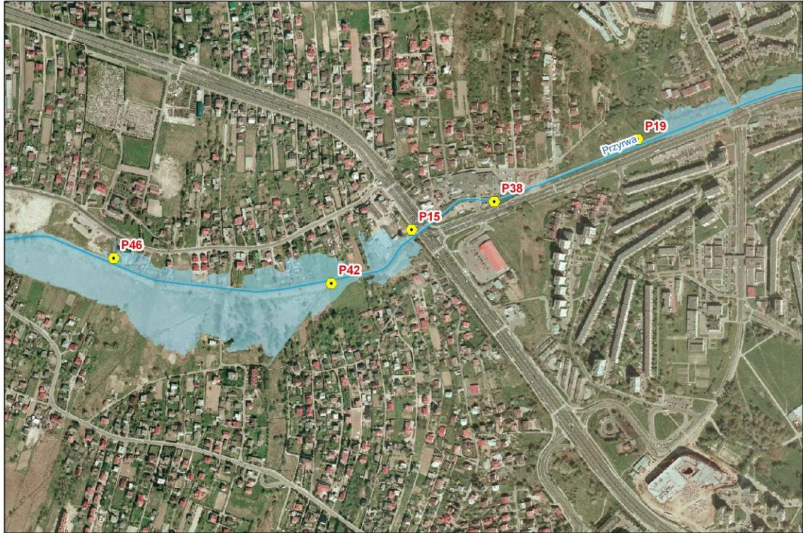
Ryc. 116. Lokalizacja wylotów kanalizacji deszczowej do potoku Przyrwa
