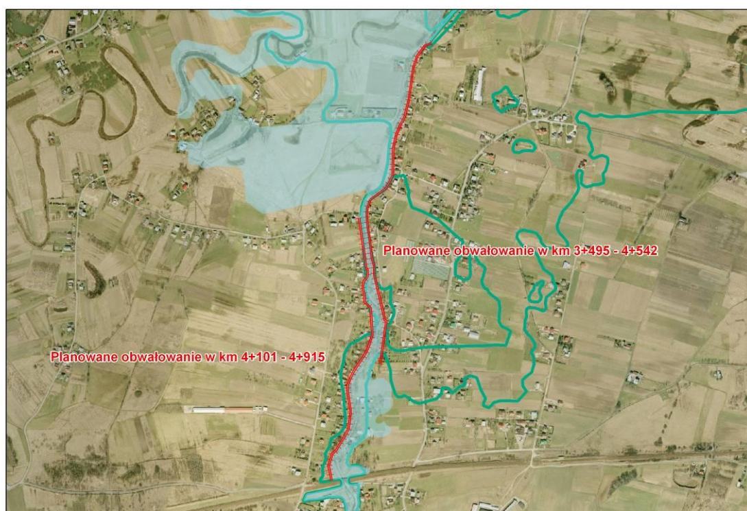
Ryc. 146. Lokalizacja planowanych odcinków wału i bulwaru na lewym i prawym brzegu Sawy
