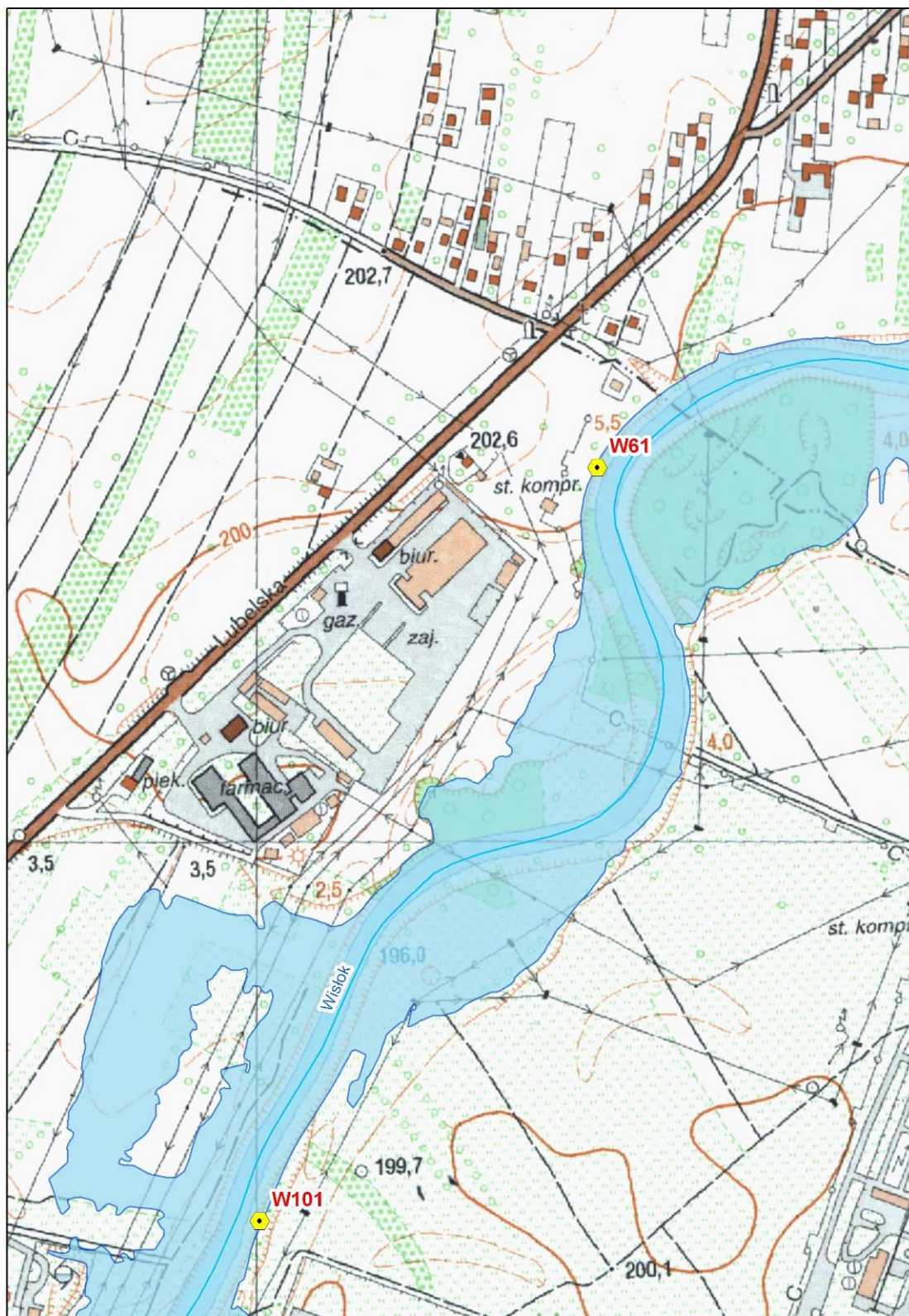
Ryc. 145. Lokalizacja wylotów kanalizacji deszczowej do Wisłoka - cz. 2
