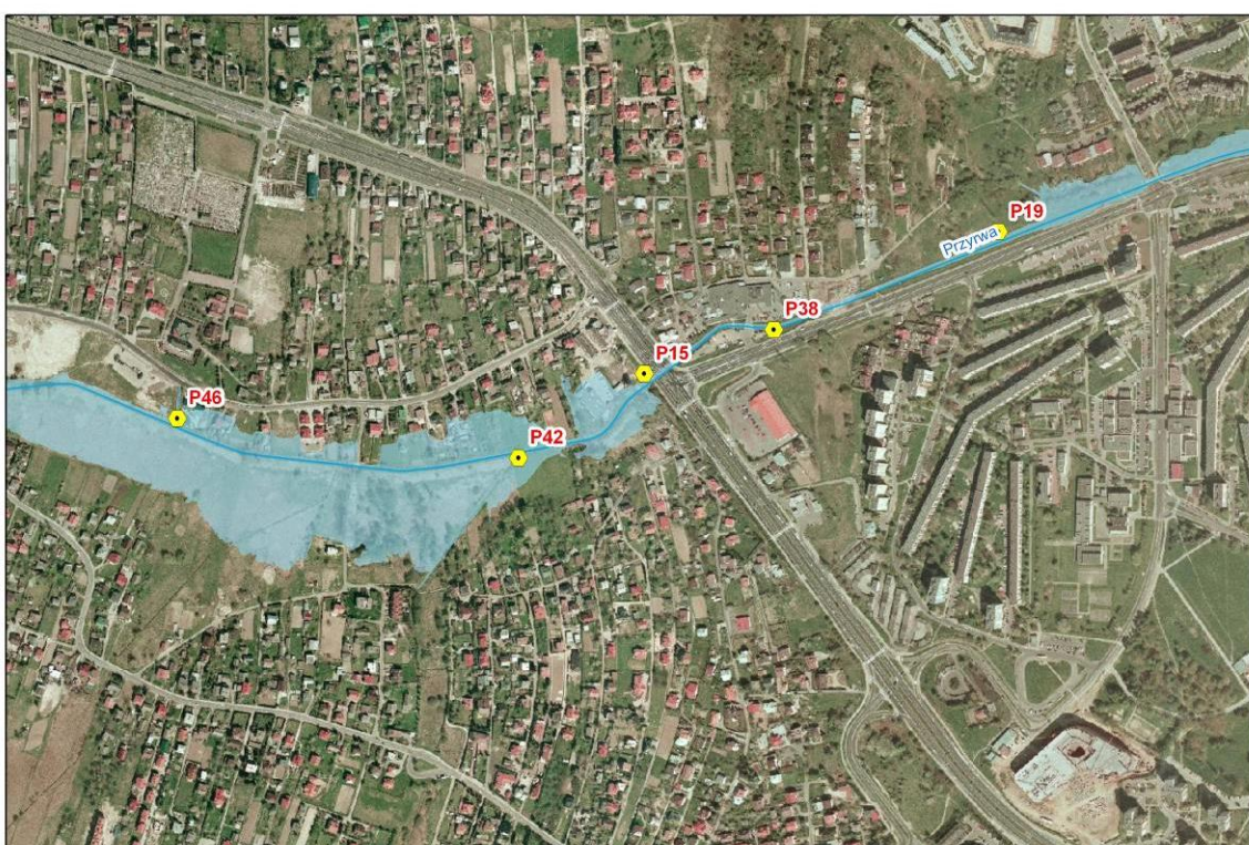
Ryc. 116. Lokalizacja wylotów kanalizacji deszczowej do potoku Przyrwa
