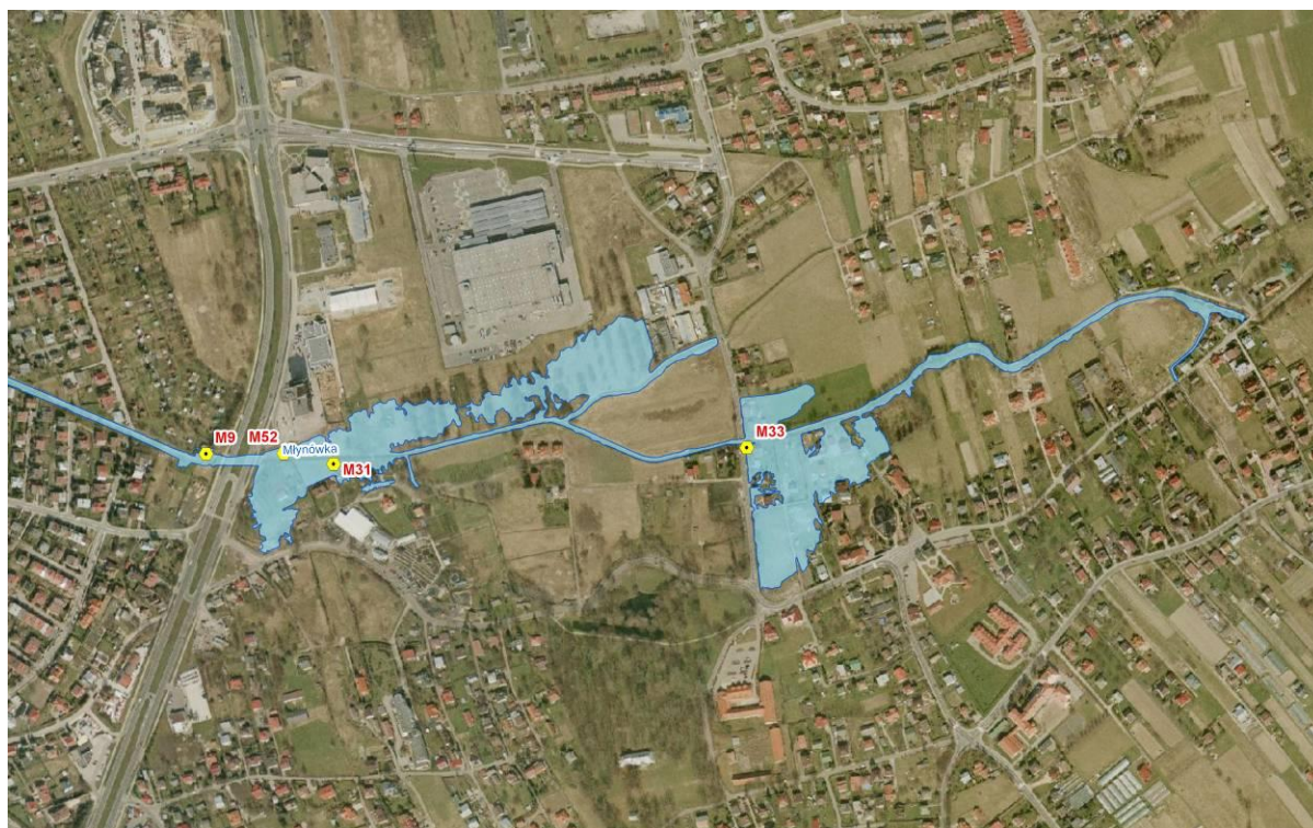
Ryc. 126. Lokalizacja wylotów kanalizacji deszczowej do potoku Młynówka Źródło: opracowanie własne na podstawie "Program rozwoju kanalizacji deszczowej dla miasta Rzeszowa" oraz ortofotomapy
