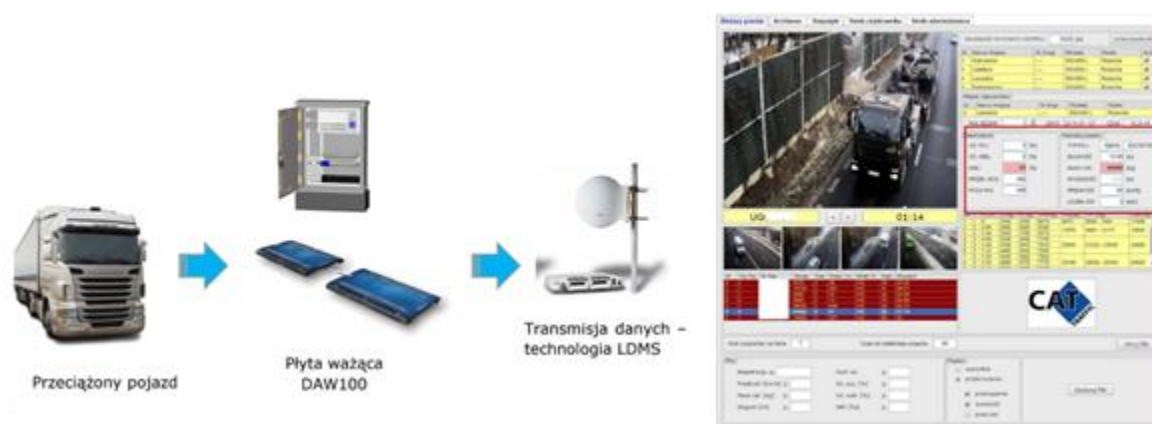
Rys. 15. Schemat generowania informacji w Systemie Dynamicznego Ważenia Pojazdów w Ruchu (preselekcja wagowa)
